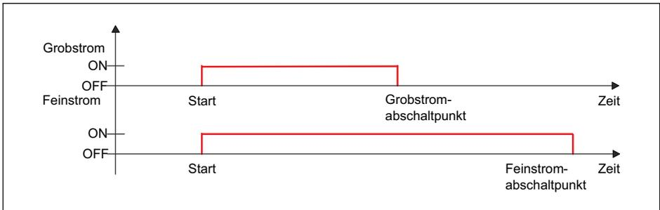
Abb. 10.3 Füllzyklus bei Ventilsteuerung Grob+Fein
